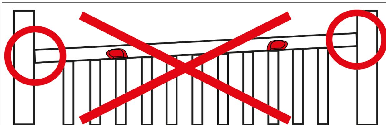
*Fig. Barandilla bloqueada incorrectamente*
