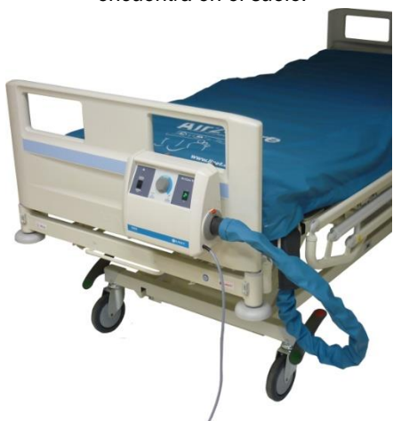
Fig. 8a Instalación de la SCU en el piecero
