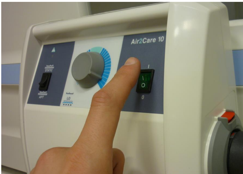
Fig. 10 Encendido de la SCU
