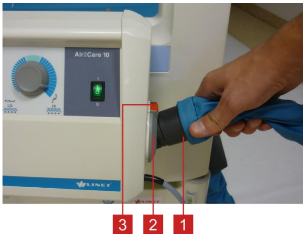
Fig. 9 Instalación de la SCU
