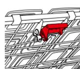
Sistema de accionamiento CPR en el respaldo
